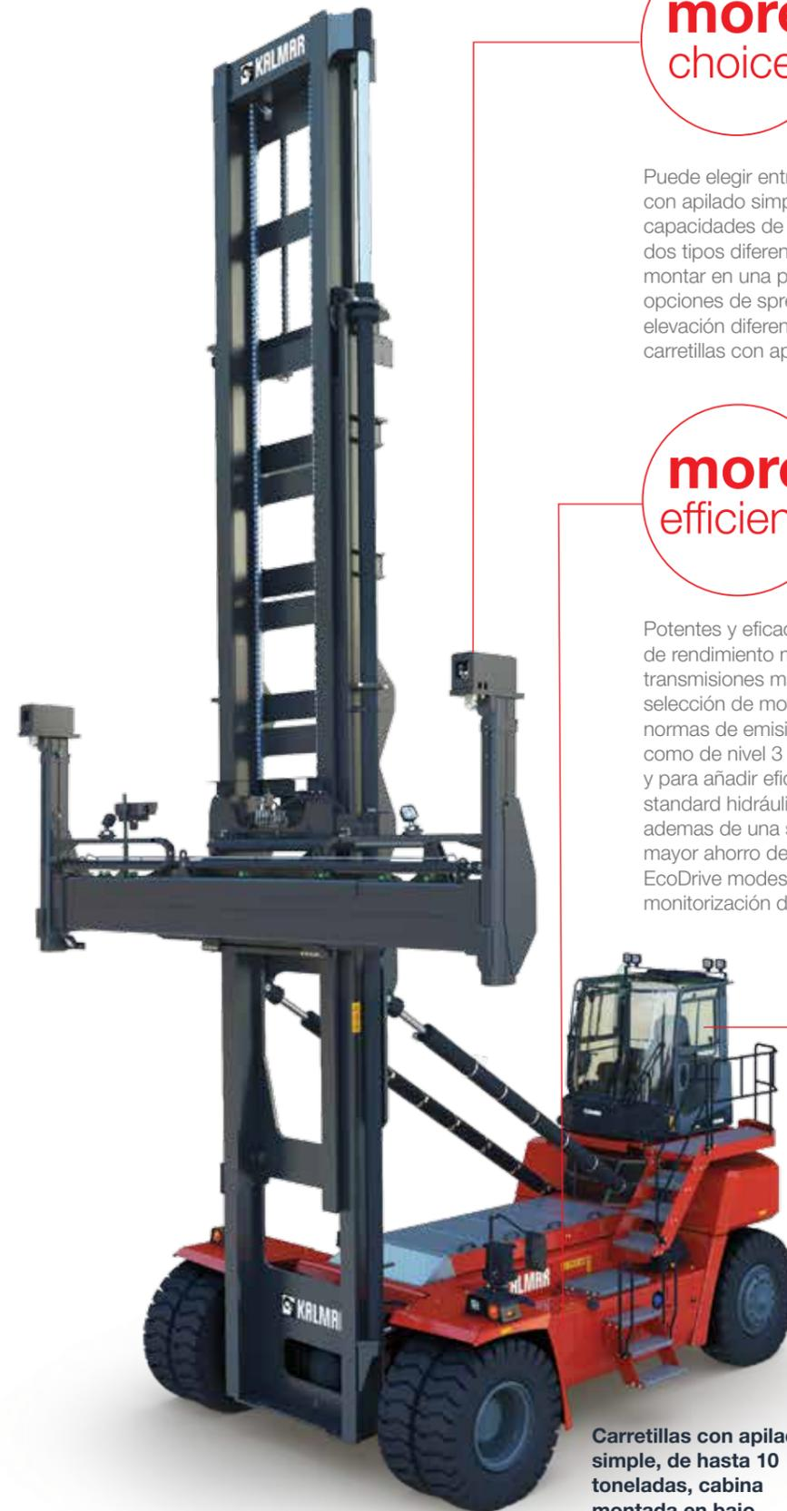
Carretillas con apilado simple, de hasta 10 toneladas, cabina montada en bajo.
